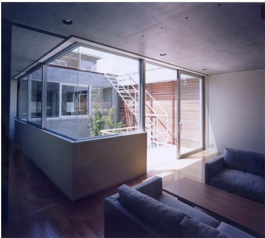
■ 居間より中庭方向を見る。中庭を囲む3辺は全てガラスにできる構造システムを採用している。居間から中庭を通して子供室までの連続感がある。
